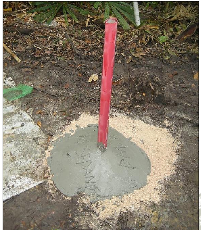
Contoh piezometer bagi memantau paras air tanah.
