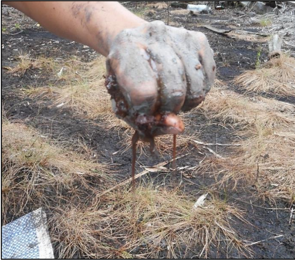
Grab and rubbing test bagi penentuan pengkelasan tanah gambut di lapangan.
