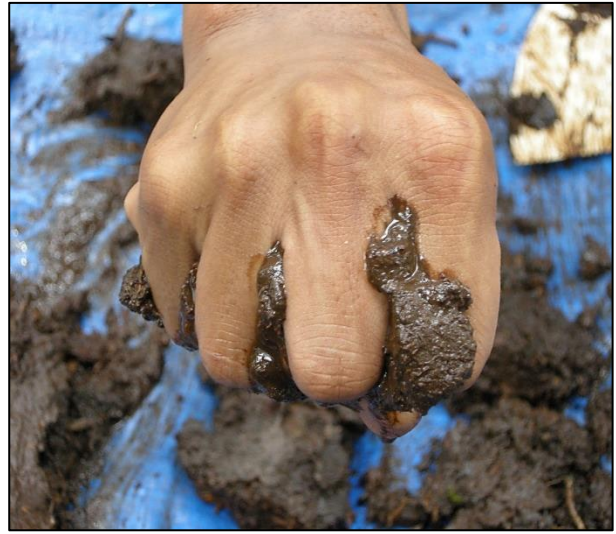
Grab and rubbing test bagi penentuan pengkelasan tanah gambut di lapangan.
